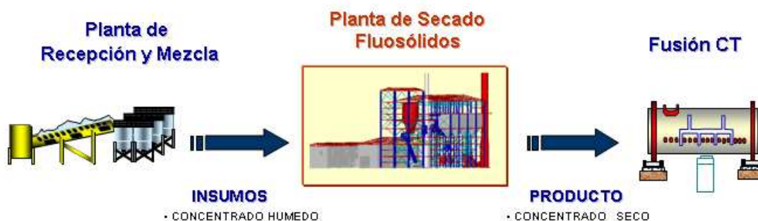
Figura 3: Esquema del proceso modificado en Fundición Salvador
